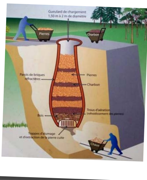
Schéma d'un four vertical à cuisson continue © Service régional de l'inventaire de Poitou-Charentes Zoé Lambert, 2007
